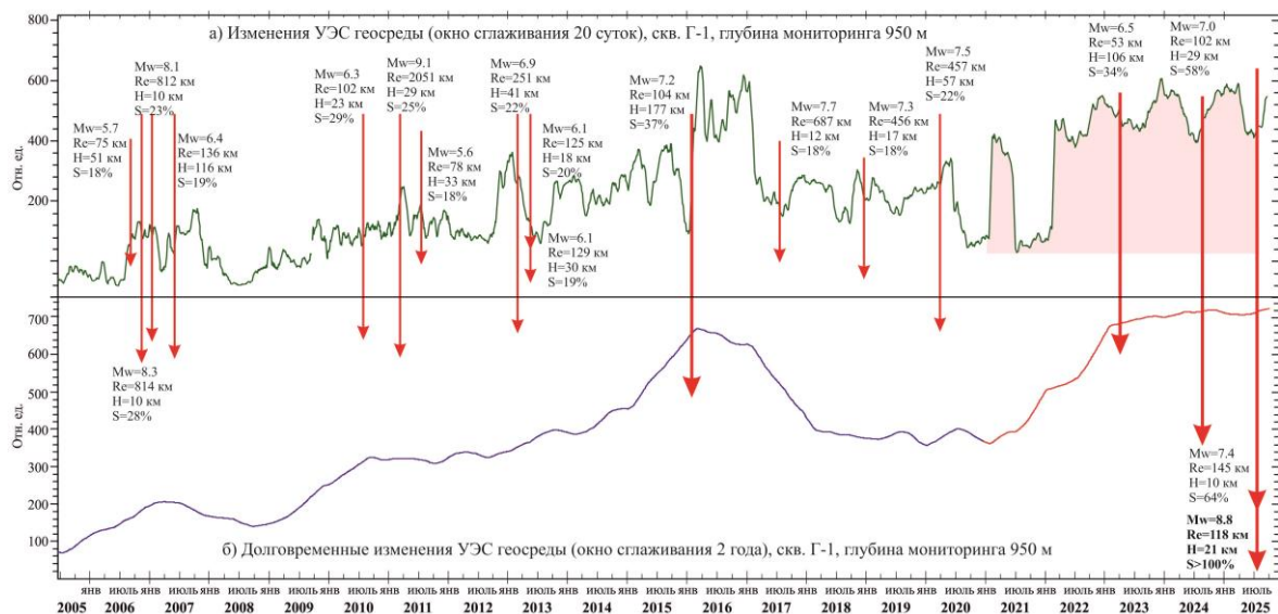
Рис. Изменения УЭС геосреды перед землетрясениями с глубиной H \leq 200 км с величиной S \geq 18\% по данным измерений на ППП с подземной электрической антенной
