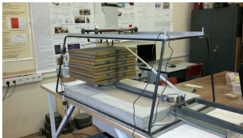
Пружинно-блочная модель разлома земной коры (слайдер С-2)
