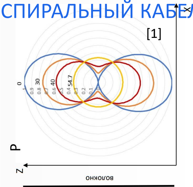
Диаграмма направленности кабеля в зависимости от намотки волокна и чувствительность в поперечном направлении
