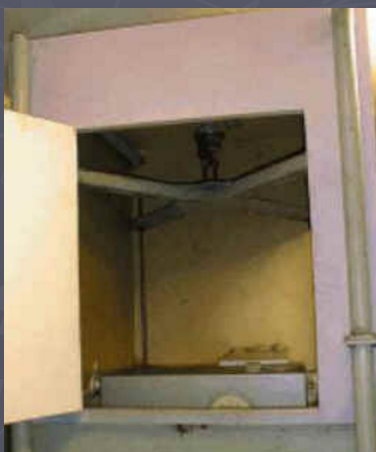
Антинаклонная платформа с горизонтальным сейсмометром (СПбГУ)
