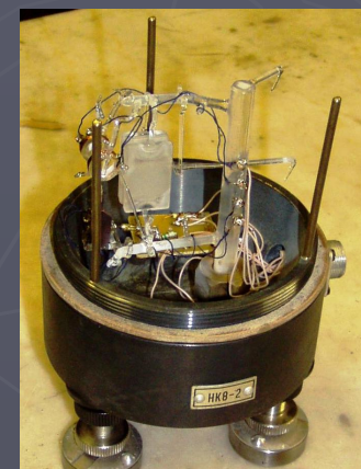
Шестикомпонентный сейсмометр KSM-1 с возможностью вычисления наклонов (ИТПЗ РАН)
