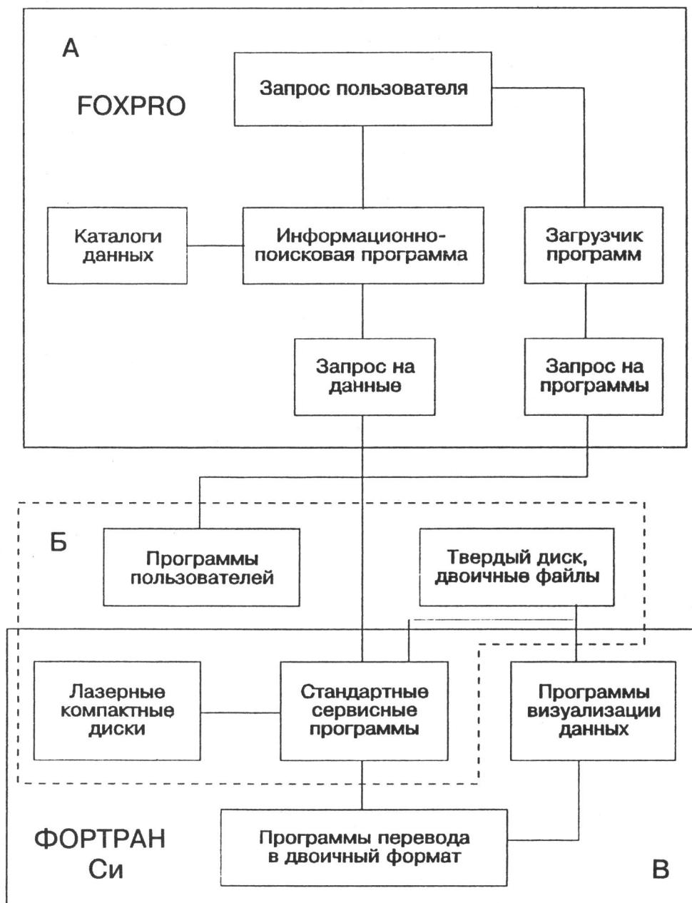
Схема интерфейса к лазерным компактным дискам
