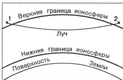
Рис. 3. Схема радиозатмения 1 – источник излучения, 2 – приемник
